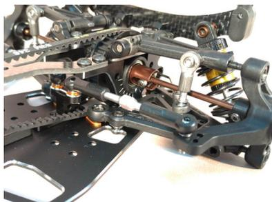
見直されたリアジオメトリーにベアリングタイプの CVD を搭載。
