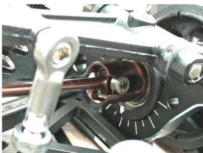
カムタイプのベアリングアダプターにより、ベルトテンション調整が可能。
