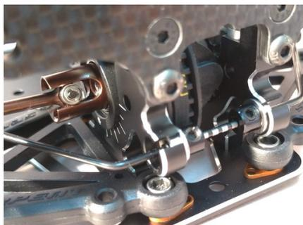
前後ロアアームはピボットボール方式でシムによりロールセンター変更が用意に素早く可能。
