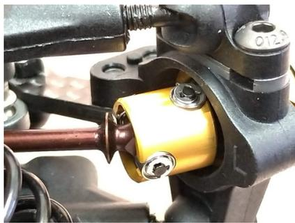
フロントのダブルダルダンもベアリングタイプとなり、極限まで駆動ロスを低減。
