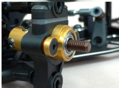
アクスル高さとおフセットを調整できる新型ステアリングブロック。従来タイプと同様に、トレッド、キャンバー変更も自在。
