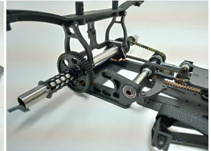
前後ともにスタンダードな 1/8 レーシング用タイヤを使用するクイックチェンジ仕様のホイールアックス。フロントステアリングブロックは GP989 と同様に細かなセットが可能。
