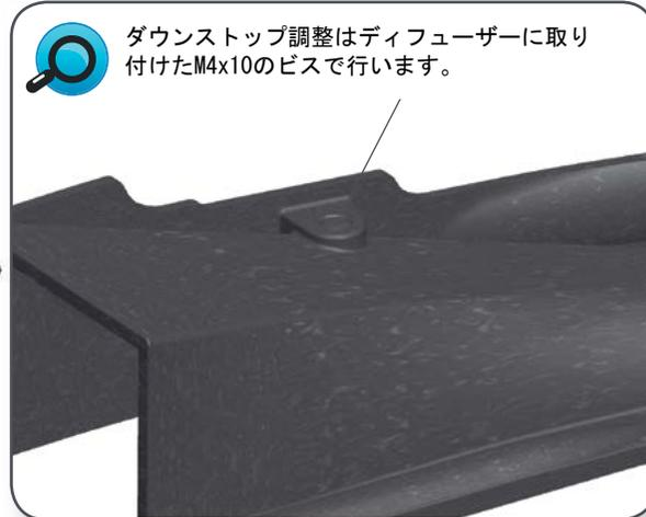
ダウストップ調整はディフューザーに取り付けたM4x10のビスで行います。
